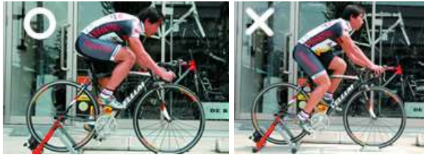
●ハンドルの下部分のストレートを地面と平行にした、旧式セッティング。ブラケット位置が遠くなるので初心者向きではない
